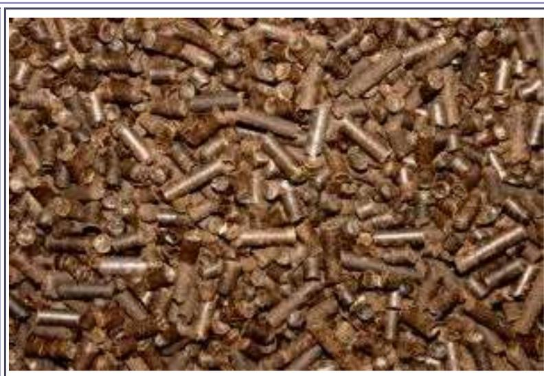
Гранулы из торфа, диаметр - 8 мм.
